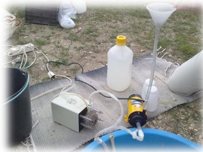
Figura 11- Montagem das bombas centrífuga e peristáltica em paralelo para captura da água de percolação.
