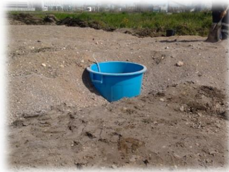
Figura 10- Colocação das cinzas de fundo sobre o lisímetro, fotografia correspondente ao Talhão 4.
