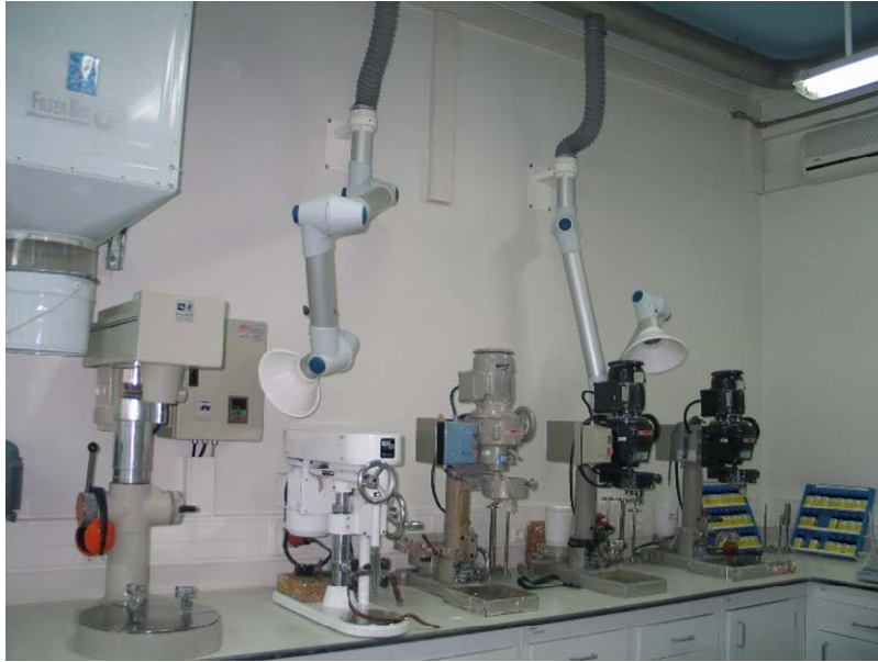
Figura 8.4 – Imagem do dispersor de alta velocidade e dos homogeneizadores utilizados na produção dos esmaltes aquosos e tintas antinódosa.
