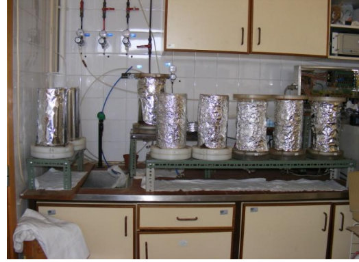
Figura 7. Montagem laboratorial dos lisímetros
