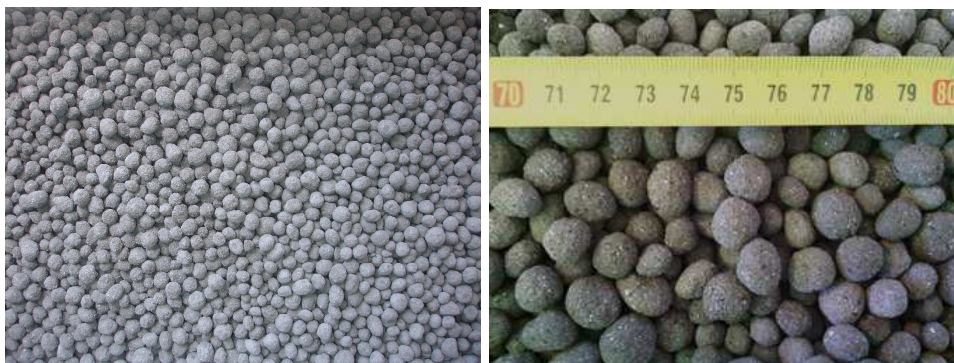
Figura 4.3 - Grânulos de cinza volante, com percentagem de 20% de água.
