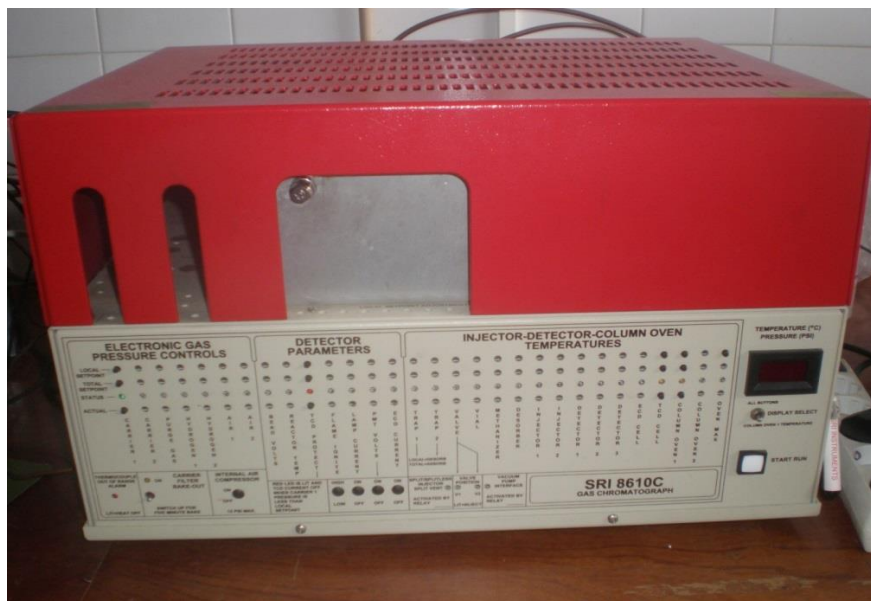
Figura 4 – Cromatógrafo gasoso usado nas análises de biogás.
