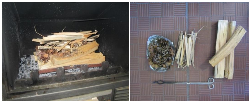
Figura 4.12. Ilustração da técnica utilizada para a realização dos ensaios de teste da técnica de ignição pelo topo.
