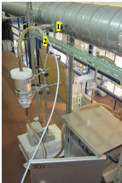
Figura 4.5. Sistema de amostragem de PM 10 : 1) Sonda de amostragem de material particulado, 2) Ponto de diluição do efluente amostrado com ar comprimido.
