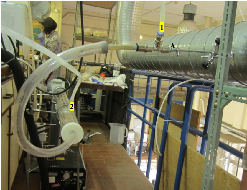
Figura 4.8. Sistema de diluição do efluente amostrado no primeiro túnel de diluição: (A) corresponde ao sistema venturi, (1) e (2) correspondem a pontos de injeção de ar comprimido.
