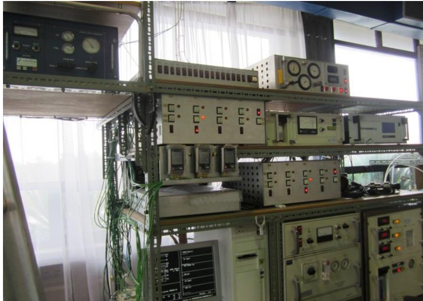
Figura 4.4. Sistema de amostragem e análise dos gases de exaustão e respetivo sistema de aquisição de dados.
