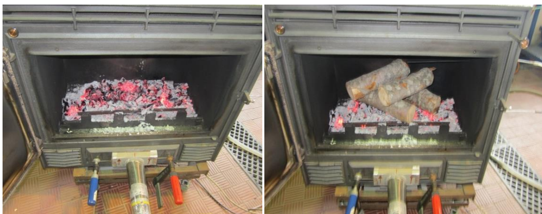
Figura 4.11. Ilustração da introdução de uma carga de combustível no leito incandescente de carbonizado.
