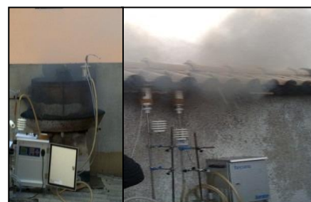
Figura 8. Amostragem na chaminé da churrascaria e do restaurante de confeção de leitões, respetivamente
