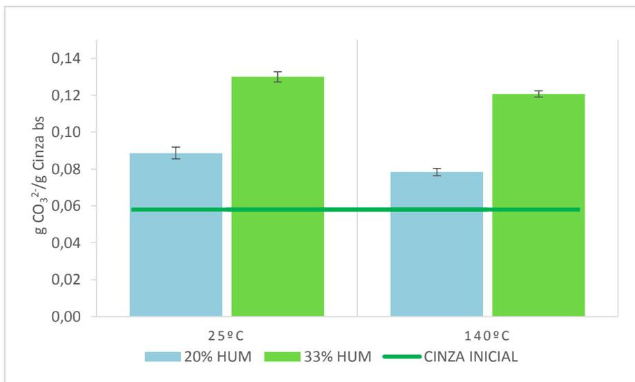
Figura 31 - Influência da humidade e da temperatura na carbonatação de cinzas volantes com uma concentração de 15% de CO<sub>2</sub> (v/v) para ensaios de duração de 20 min.
