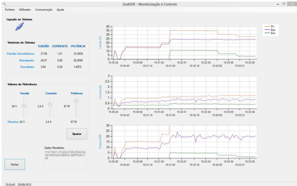
Figura 5.10: Janela de monitorização e regulação
