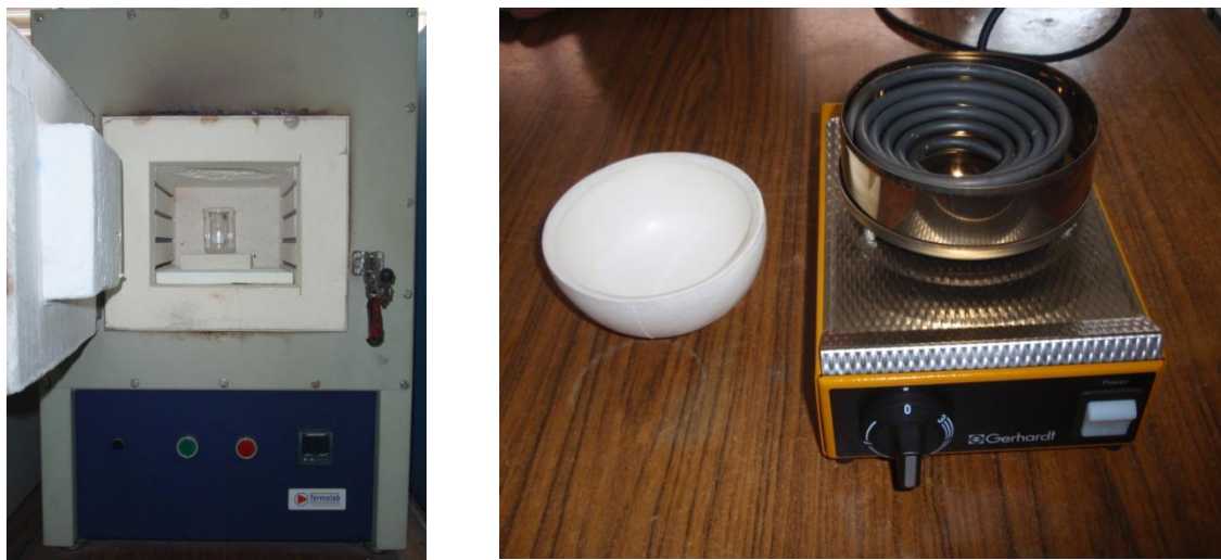
Figura 8 – Aparato experimental para os dois métodos utilizados. À esquerda o forno e à direita a placa de aquecimento.
