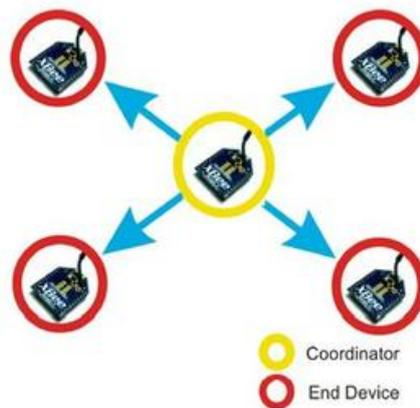
Figura D.2: Montagem *Star* de uma rede *Zigbee****Router***
