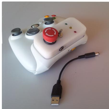
Figura 3.10: Comando E-Stop implementado no AtlasCar com o cabo de alimentação
