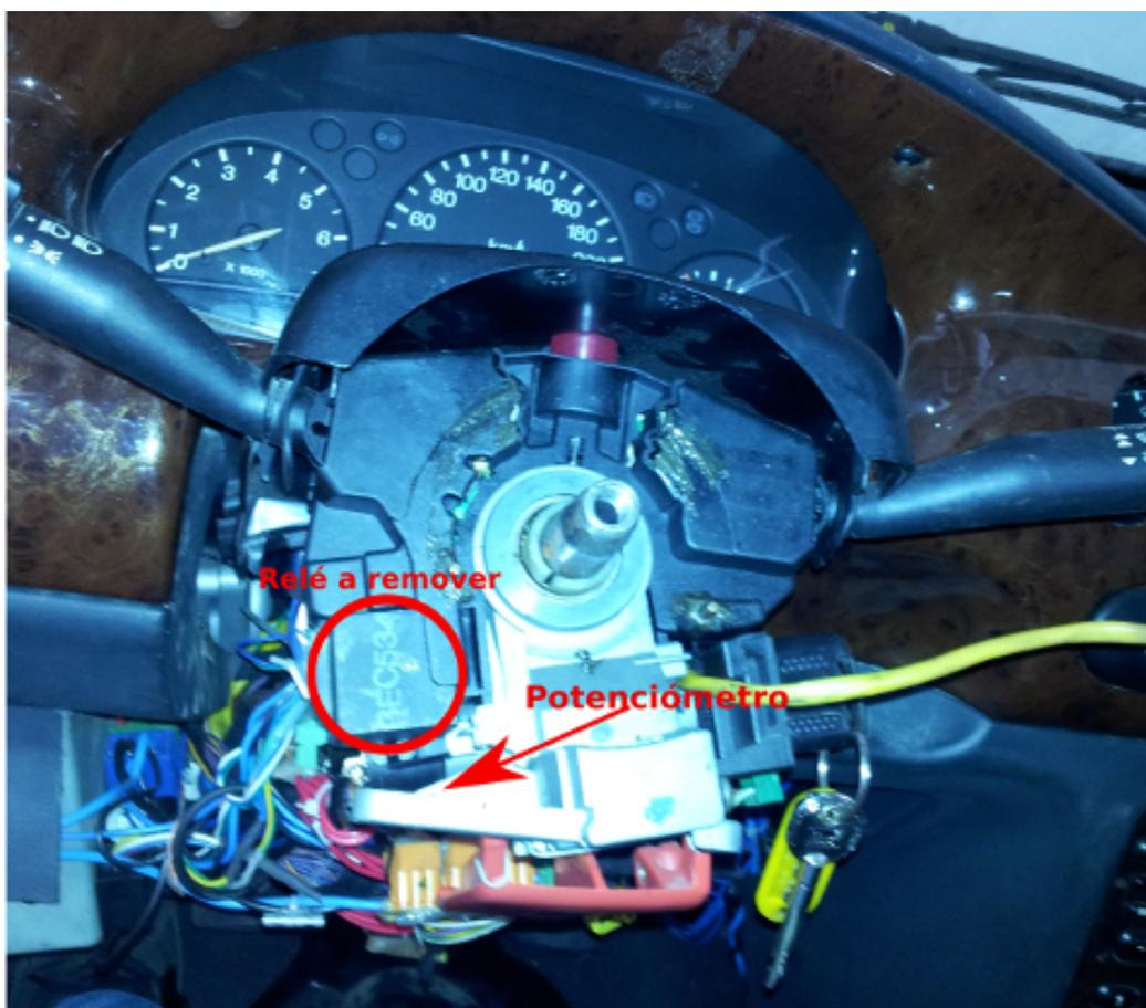
Figura 2.12: Esquema do novo posicionamento do potenciómetro de medição da posição do volante
