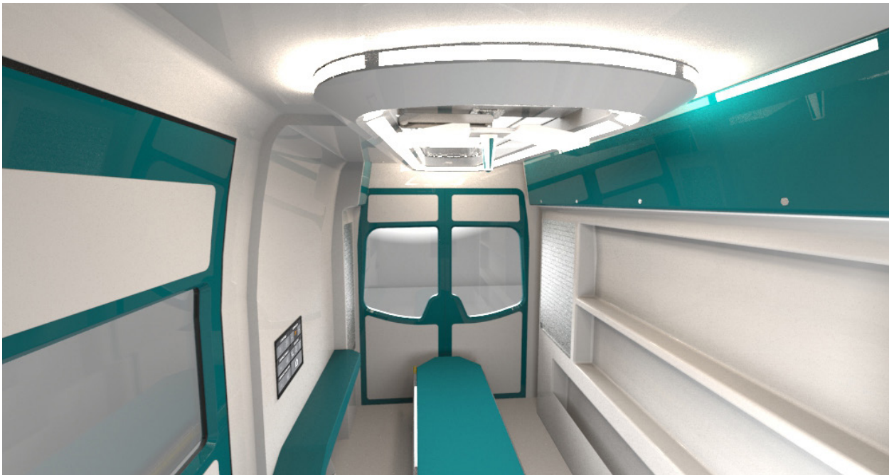
57 Renderização fotorrealista da integração do sistema de iluminação desenvolvido no interior de uma ambulância. Simulação diurna. (Gregório Rodrigues, 2013)
