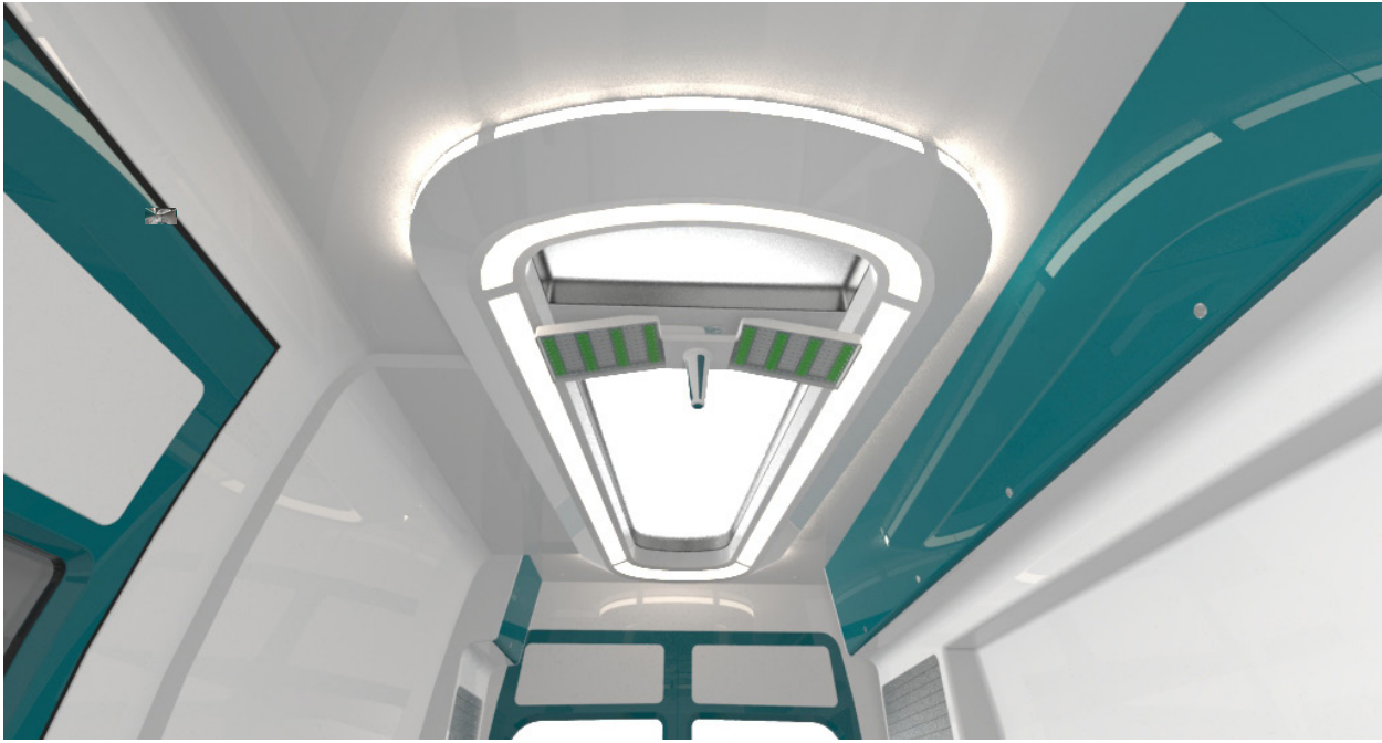
56 Renderização fotorrealista da integração do sistema de iluminação desenvolvido no interior de uma ambulância. Simulação diurna. (Gregório Rodrigues, 2013)
