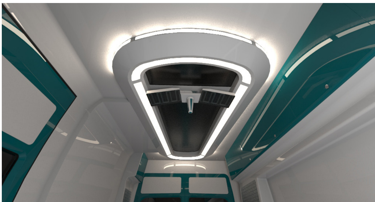
65 Renderização fotorrealista da integração do sistema de iluminação desenvolvido no interior de uma ambulância. Simulação Noturna. (Gregório Rodrigues, 2013)
