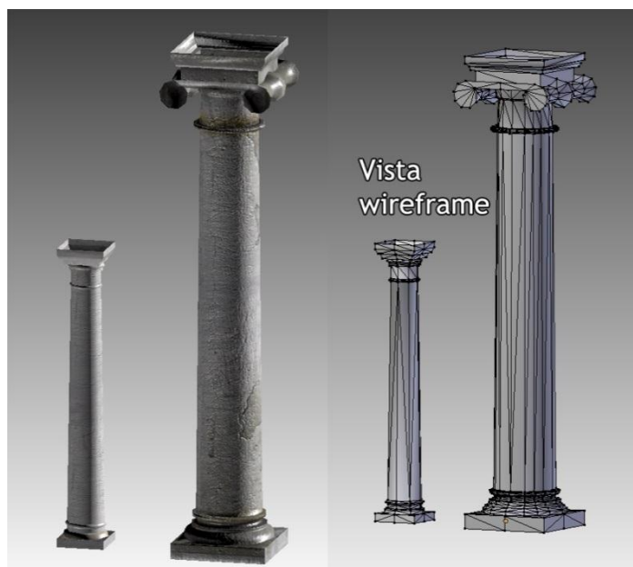
Figura 27 – Coluna piso superior (esquerda) e Coluna piso inferior (direita) em modo render e wireframe 69
