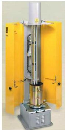
Figura 28 - Equipamento de ensaio de Proctor (imagem retirada da internet)
