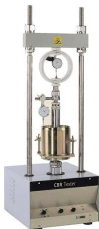
Figura 29 - Equipamento de teste CBR (imagem retirada da internet)
