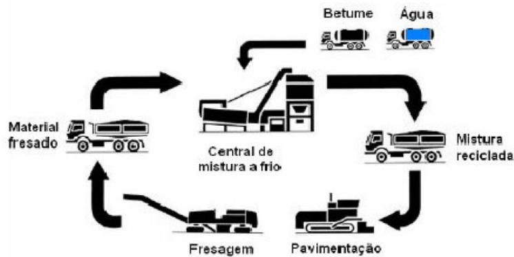
Figura 17 - Reciclagem em central a frio com betume-espuma (Martinho, 2005)
