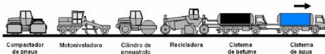
Figura 14 - "Comboio de reciclagem" em reciclagem "in situ" a frio com betume-espuma (Picado-Santos et al, 2011)
