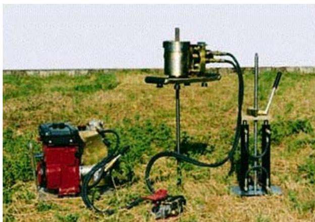
Figura 35 - Penetrómetro DPM 30-20 (imagem retirada da internet)
