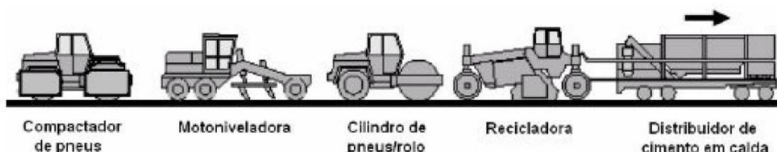
Figura 12 - "Comboio de reciclagem" em reciclagem "in situ" a frio com cimento (Picado-Santos et al, 2011)
