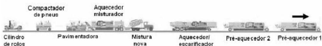
Figura 15 - "Comboio de reciclagem" em reciclagem "in situ" a quente com rejuvenescedor (Picado-Santos et al, 2011)
