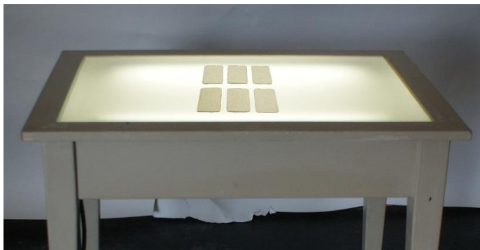
Figura 64 - Método de exposição: mesa de luz com temporizador
