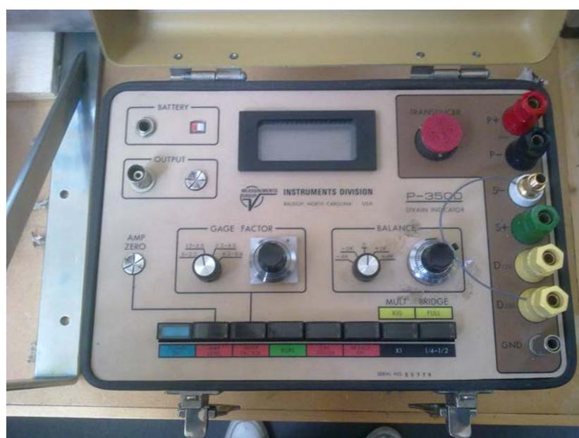
Figura 5.4: Comparador utilizado para retirar os valores da deformação nos eixos OX e OY.
