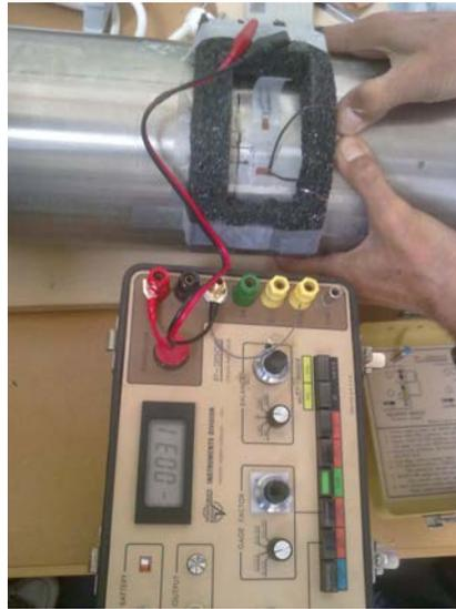
Figura 5.5: Ligação do comparador aos extensómetros soldados no tubo.
