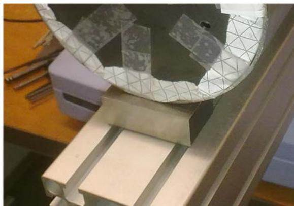
Figura 5.6: Calços de aço na extremidade do tubo.
