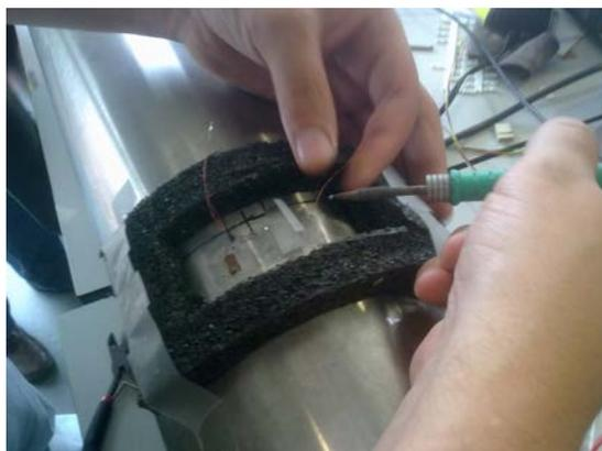
Figura 5.3: Soldadura dos extensómetros ao tubo.
