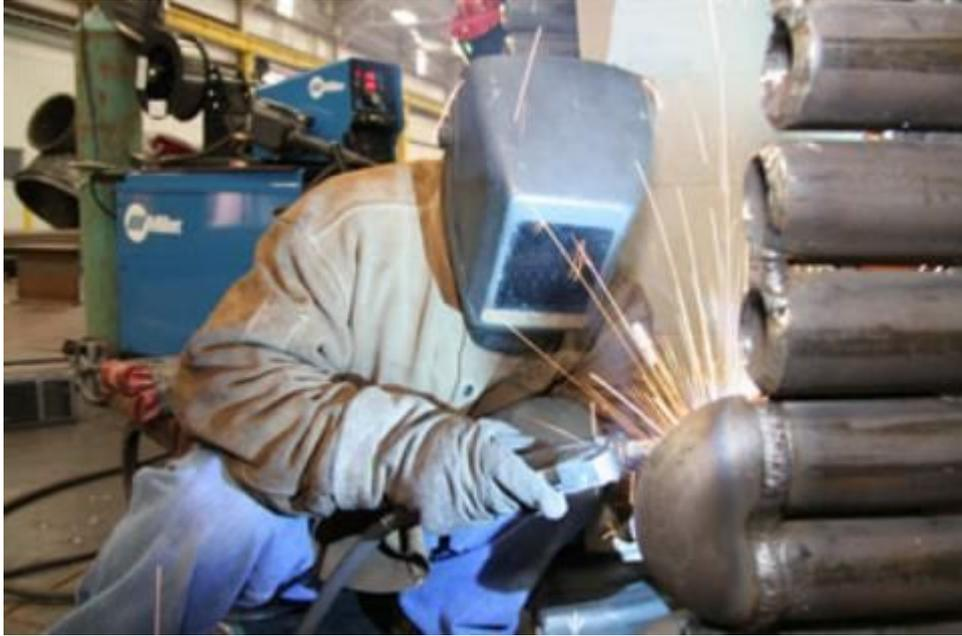
Figura 1.10: Soldadura de duas estruturas tubulares [62].
