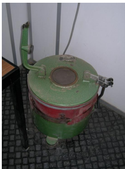
Figura III.2: Agitador N.V. TEMA: (a) agitador antes da colocação do moinho de ágata; (b) agitador depois de colocar o moinho de ágata.
