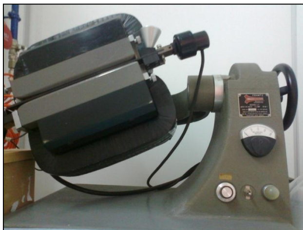
Figura III.4: Separador magnético Frantz , com inclinação a 20° na horizontal e 10° na horizontal.
