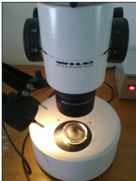
Figura III.6: Lupa binocular WILD utilizada na separação de zircões e material auxiliar.
