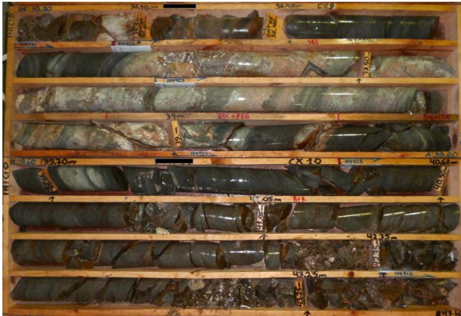
Foto 7 – Caixas de sondagem com xisto, skarn e veio pegmatítico depois do efetuado o log e a marcação da amostragem.
