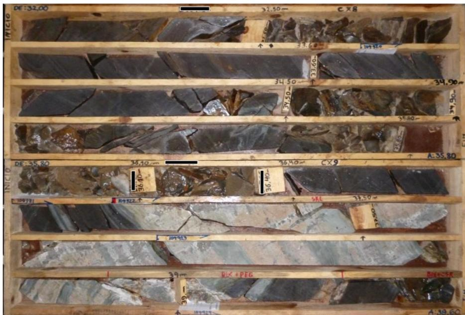
Foto 8 – Caixas de sondagem com testemunhos já amostrados.
