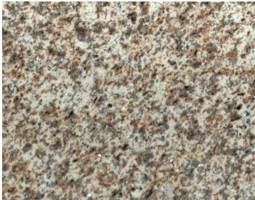
Figura 9. – Fotografia macroscópica, granito Amarelo Macieira
