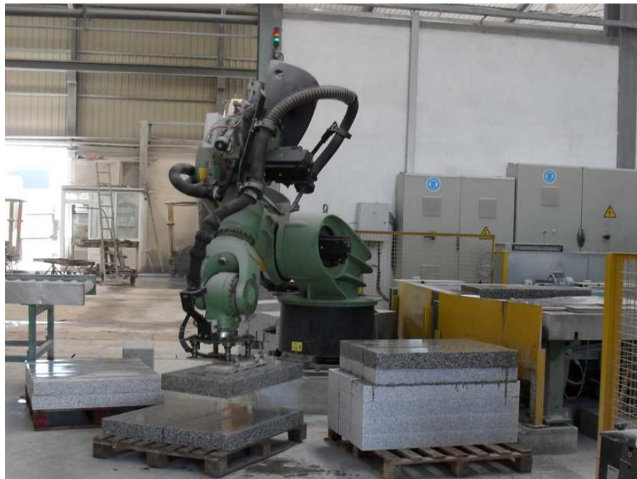
Figura 34.- Pormenor do robot nº1 a descarregar
