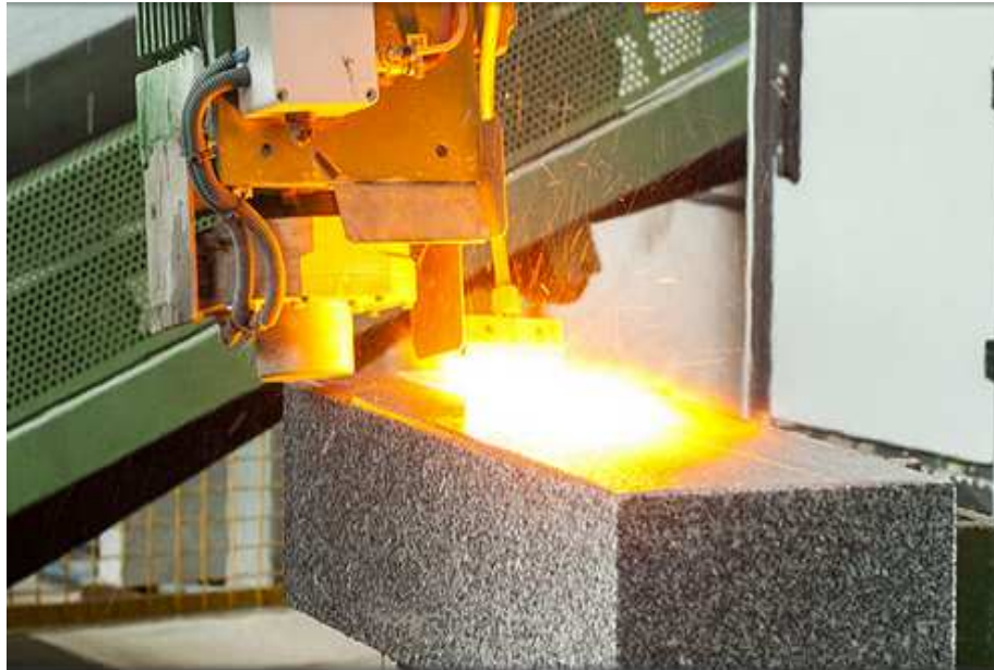
Figura 35.- Pormenor do robot nº1 a flamejar uma face de um lancil
