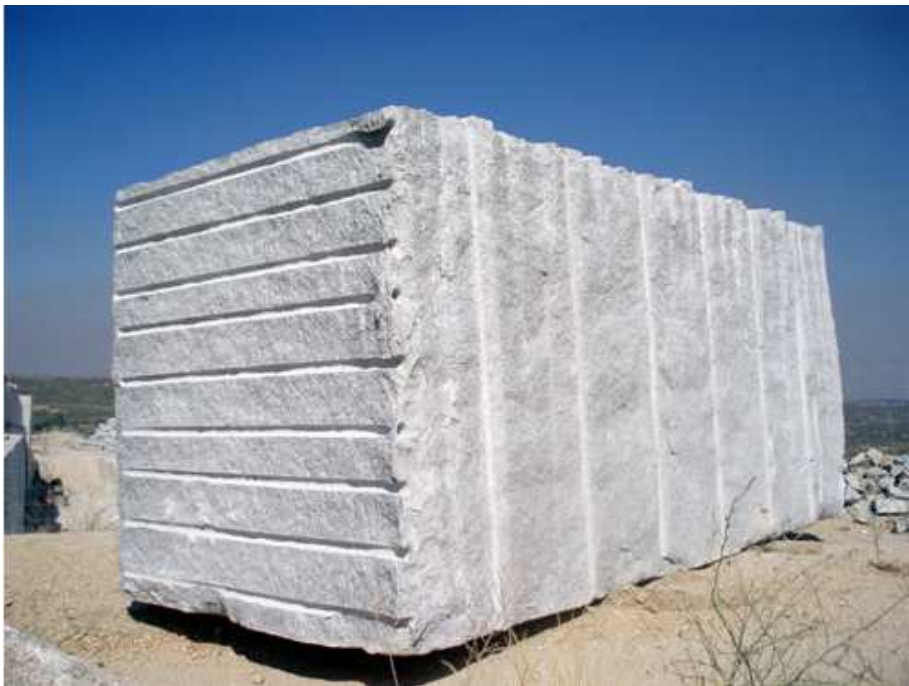
Figura 24. – Fotografia ilustrativa de um bloco de 1ª Qualidade (P)
