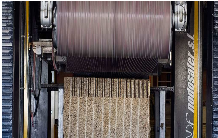
Figura 29. – Observação de um pormenor de um tear multifios – Serragem com 54 fios
