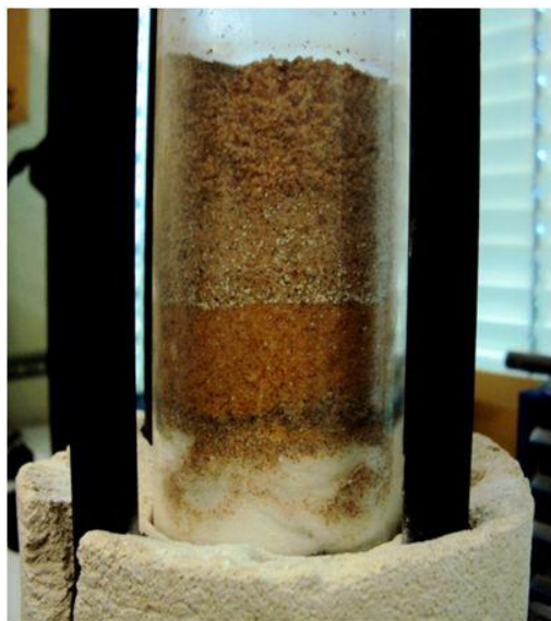
Figura 5.13 - Aspeto visual do reator de um leito desfluidizado ( T_{const}=700\text{ °C} , amostra C)
