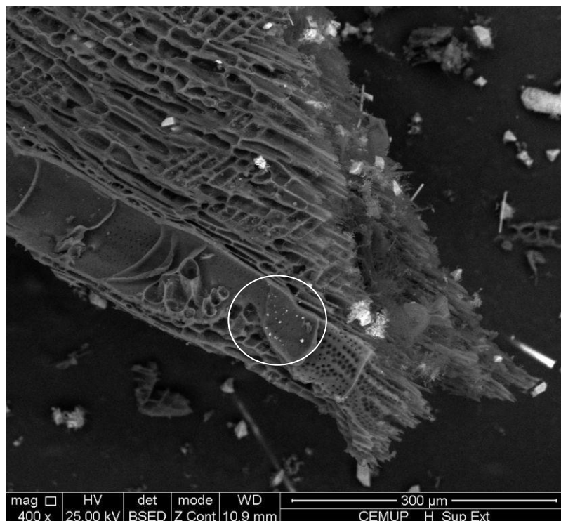
Figura 6.38 - Análise SEM da partícula fraturada de carbonizado parcialmente atacada (amostra H - superfície exterior, elétrões retrodifundidos)
