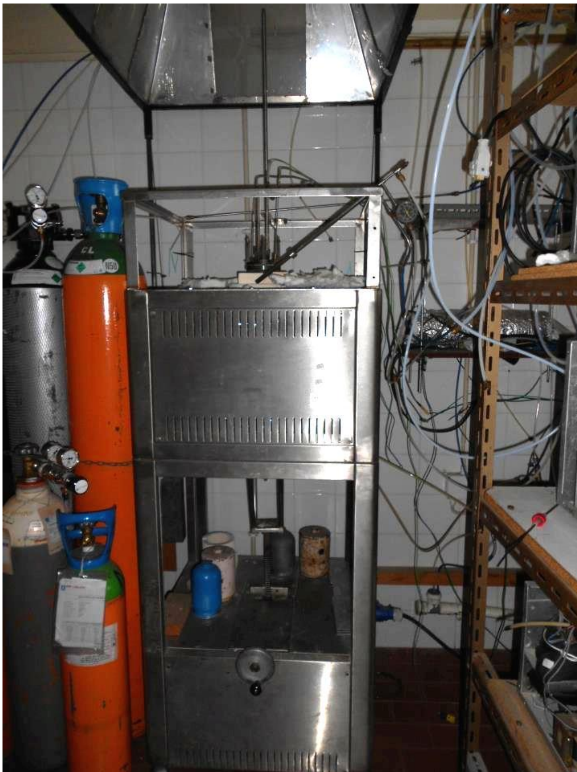
Figura 3.2 - Sistema experimental utilizado para combustões em leito fluidizado
