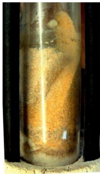
Figura 5.14 - Aspeto visual do reator de leito desfluidizado com aglomerados ( T_{const}=700\text{ °C} , amostra C) 1
