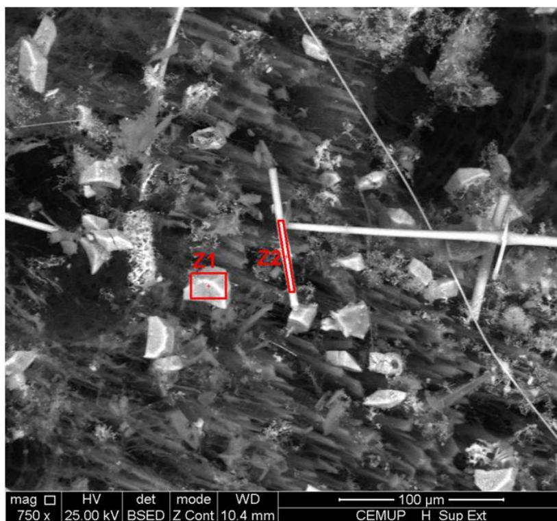
Figura 6.42 - Análise SEM do carbonizado parcialmente atacado e fraturado - pormenor da superfície externa (eletrões retrodifundidos, amostras H (Z1) e H (Z2))
