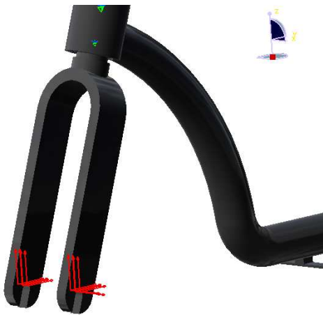
(c) Restrição XYZ na forquilha frontal
