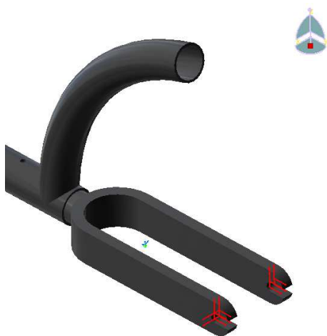
(e) Restrição XYZ na forquilha traseira
