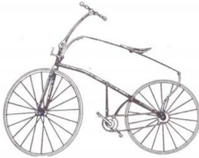
Figura 2.10: Primeira bicicleta com corrente de transmissão de Guilmet-Meyer [14]
