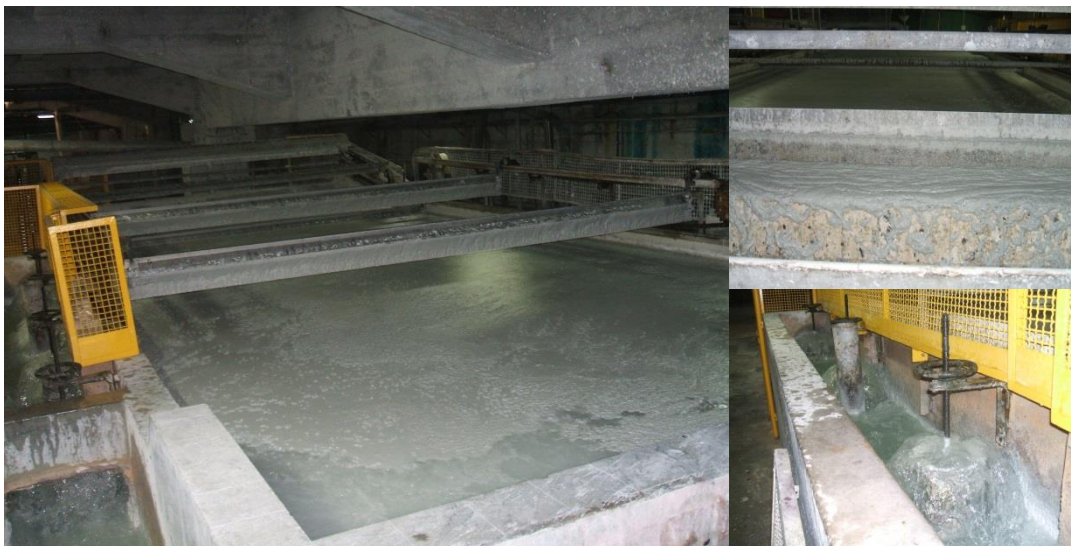
Figura 5- Sveen da MP1 com o tanque de flotação (à esquerda) a rampa de recolha de pasta (à direita em cima) e corrente de água clarificada (à direita em baixo).
