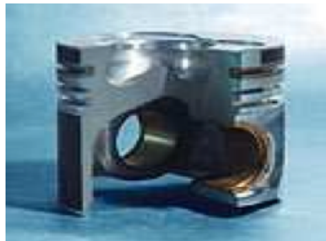
Figura 4.7: Pistão com segmentos e anilhas no pin boss
