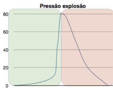
Figura 10.2: Influência da ignição na pressão da ignição em bar em função do tempo em segundos para uma velocidade de funcionamento de 3000rpm. Fase verde-Compressão Fase Vermelha-ignição
