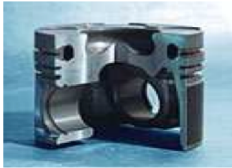
Figura 4.10: Pistão com segmentos arrefecidos
