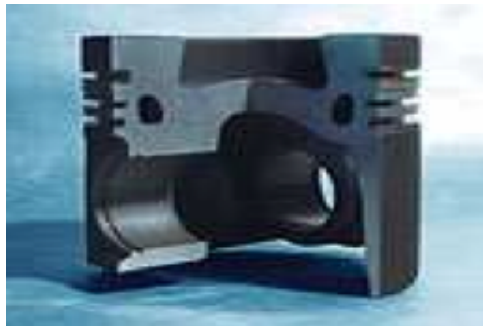
Figura 4.9: Pistão com segmentos, canal de arrefecimento e coroa reforçada
