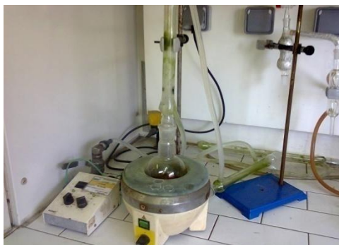
Figura 2.5 – A mistura reacional em refluxo
