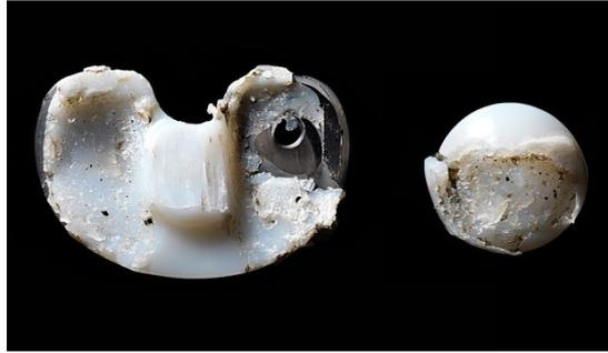
Figura 4.1 - Desgaste de uma prótese [8].
