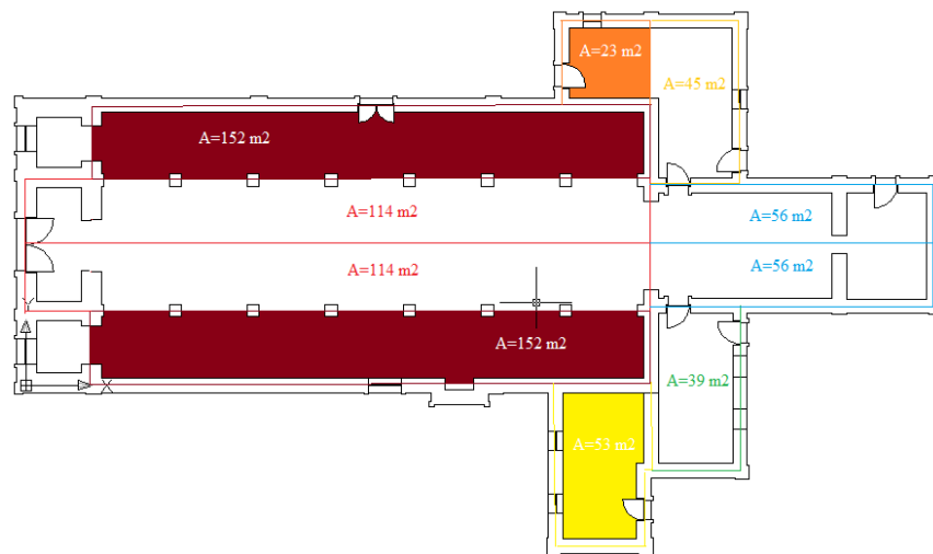
Figura B. 1. Planta com áreas da cobertura.
