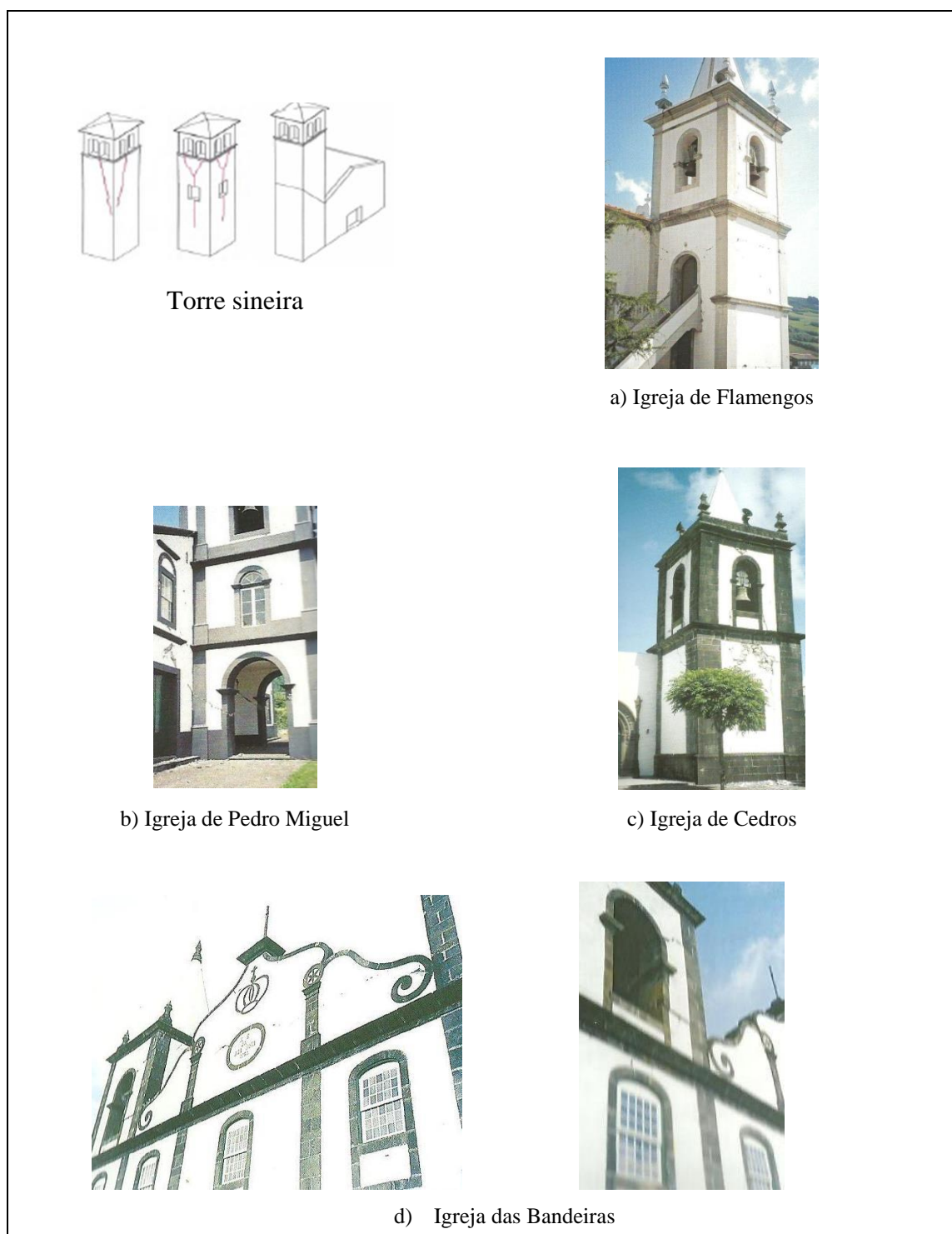
Figura 12. Mecanismos de movimento das torres sineiras (Azevedo & Guerreiro, 2008).
