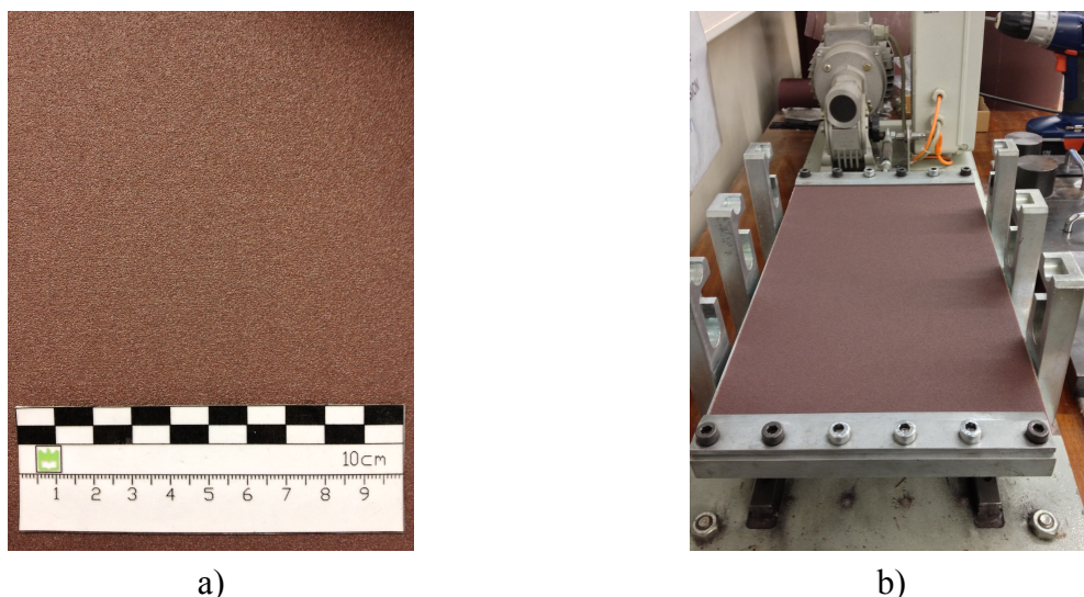
Figura 11 - Película abrasiva P100: a) vista em pormenor; b) aplicação na placa inferior do equipamento de simulação da abrasão.
