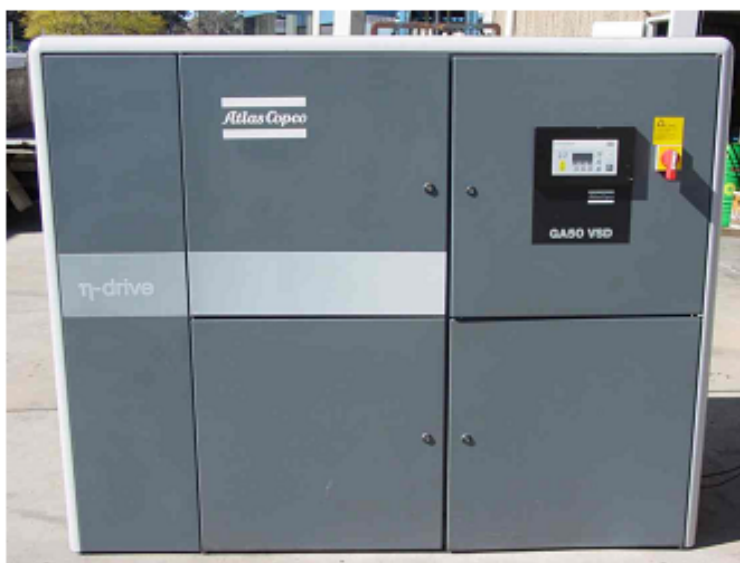
Figura 19 - Compressor Atlas Copco GA 50 VSD
