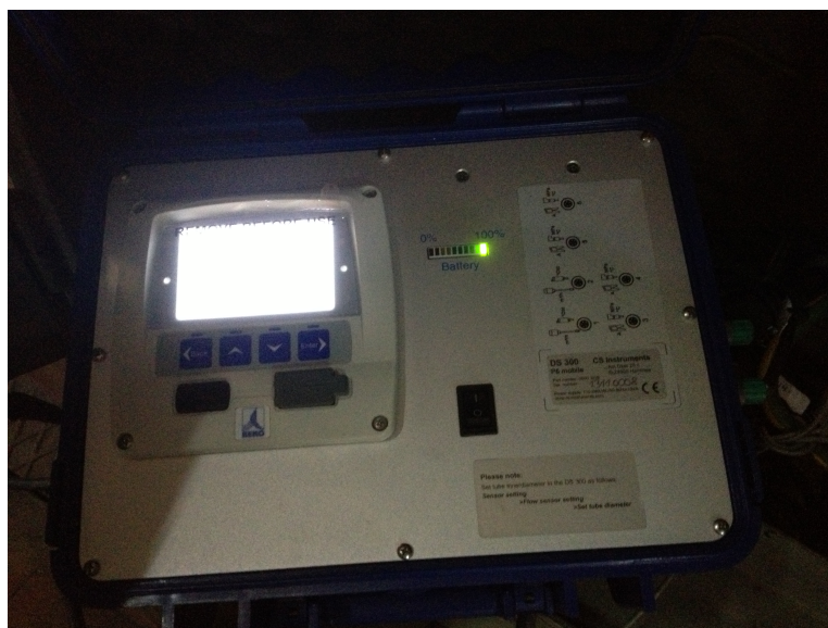
Figura 19 - Equipamento de monitorização do ar comprimido
