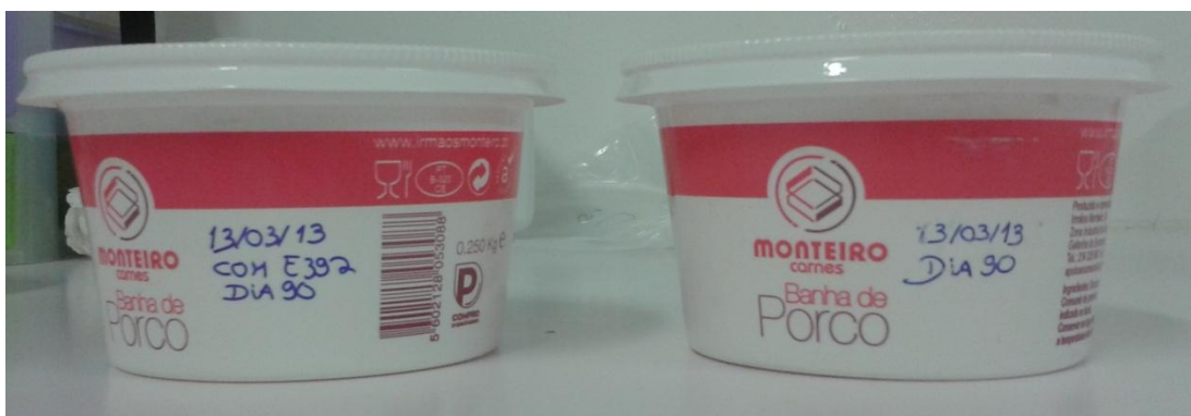
Figura 16 - Amostras de banha de porco: com E 392 (à esquerda) e sem antioxidante (à direita).
