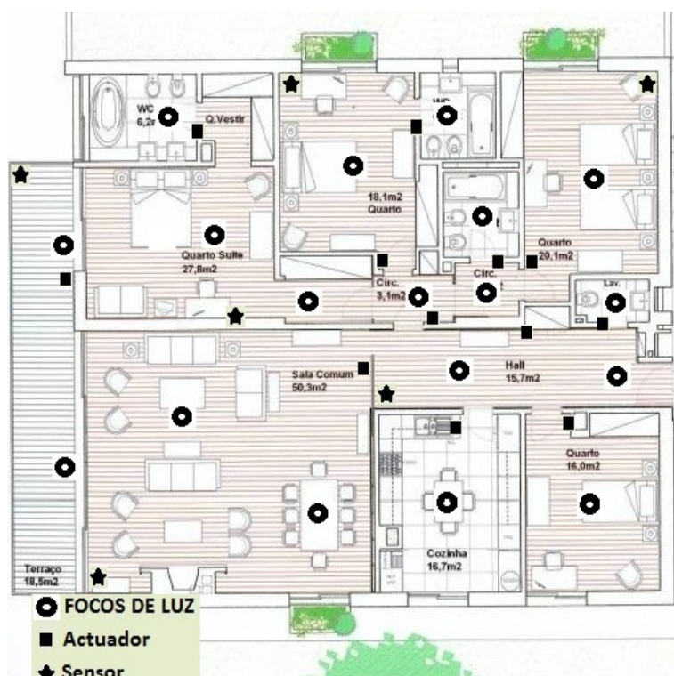
Figura 3.11: F1 Habitações T4 com plano de Sistema LEGRAND proposto.
