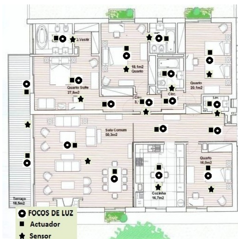
Figura 3.8: F1 Habitações T4 com plano de sistema ESYLUX proposto.
