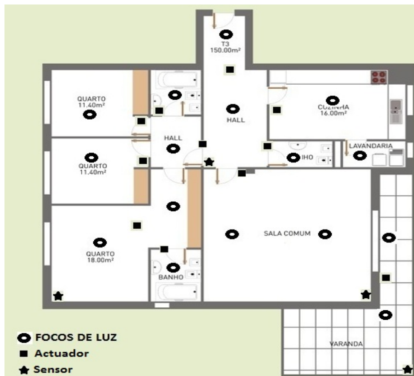
Figura 3.10: F1 Habitações T3 com plano de sistema LEGRAND proposto.
