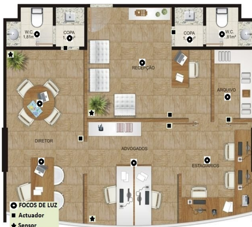
Figura 3.12: F1 Planta de Escritórios com plano de sistema LEGRAND proposto.
