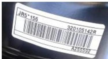
Figura 2: Etiqueta com código de barras de identificação das Caixas de Velocidades, (Fonte: Renault, 2013)
