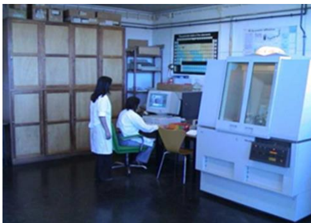
Fig. 6.1 Difractómetro existente no laboratório do departamento de geociências, UA.
