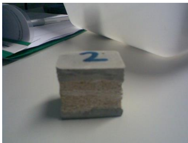
Fig. 6.12 Pormenor do provete da amostra com a referência 2, para ensaiar tendo em vista a sua resistência mecânica
