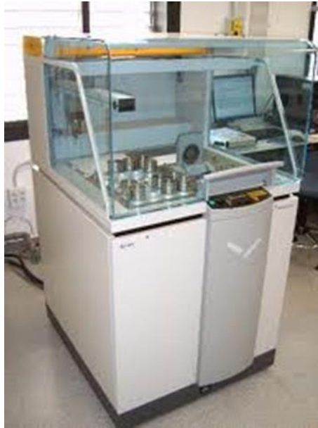
Fig. 6.2 Equipamento de FRX existente no laboratório do departamento de geociências, UA
