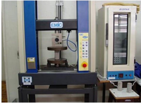
Fig. 6.13 Equipamento utilizado na medição da resistência mecânica dos provetes
