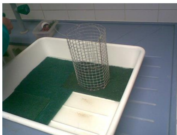
Fig. 6.10 Geotêxtil e um cesto utilizados de medição de absorção de água
