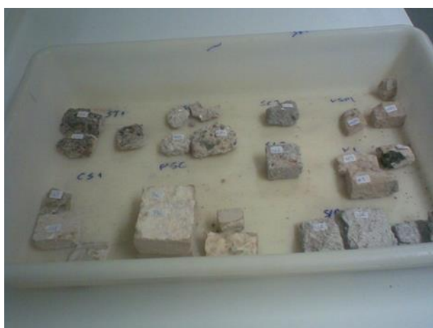
Fig. 6.9 Conjunto de Amostras que foram preparadas para a realização do ensaio de capilaridade
