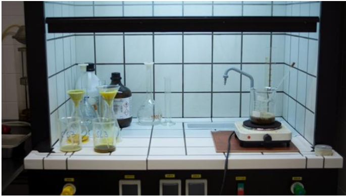
Fig. 6.5 Hotte com os equipamentos e reagentes existentes na realização da dissolução ácida
