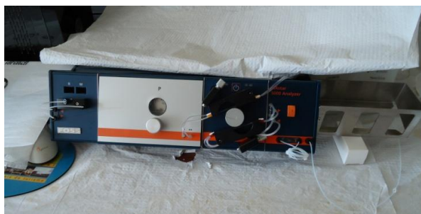
Figura 3.4 – FIAstar 5000 (equipamento utilizado na determinação de nitratos).
