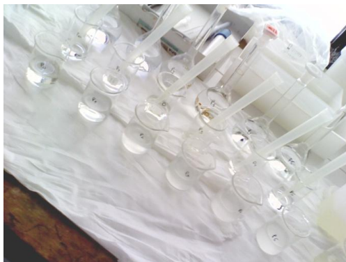
Figura 3.6 – Formação do precipitado coloidal nos padrões para a determinação de sulfatos.
