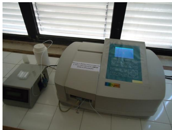
Figura 3.2 – Espectrofotómetro utilizado na leitura das absorvâncias para a determinação de fósforo.
