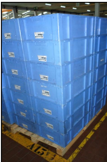
Figura 32 – Número máximo de caixas por posição: 7 \times 4 = 28 (tamanho XL)
