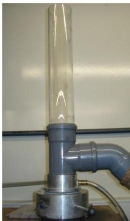
Figura 5. 14: Ensaio de permeabilidade normal ao plano – Sistema de aperto do equipamento
