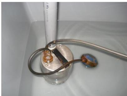
Figura 5. 6: Ensaio de permeabilidade no plano – Equipamento de bombagem utilizado
