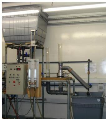
Figura 5. 12: Equipamento utilizado para a elaboração do ensaio de permeabilidade normal ao plano do geossintético
