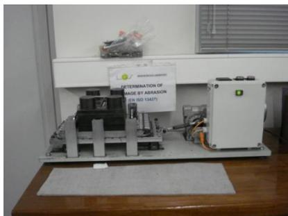
Figura 5. 19: Equipamento utilizado para a realização do ensaio de dano por abrasão
