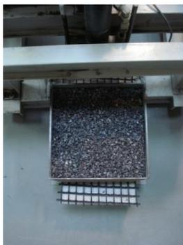
Figura 5. 18: Ensaio de dano mecânico – caixa pronta a ser posicionada para a realização o ensaio
