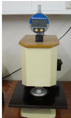
Figura 5. 4: Preparação dos provetes para a realização dos ensaios hidráulicos – Equipamento que mede a espessura dos provetes enquanto se encontram secos
