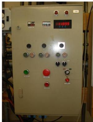
Figura 5. 7: Ensaio de permeabilidade no plano – quadro elétrico que permite o controlo da tensão exercida no provete
