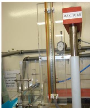
Figura 5. 8: Ensaio de permeabilidade no plano – tubo piezométrico a montante do geossintético, descarregador de superfície a jusante e aparelho que permite a medição da espessura do provete
