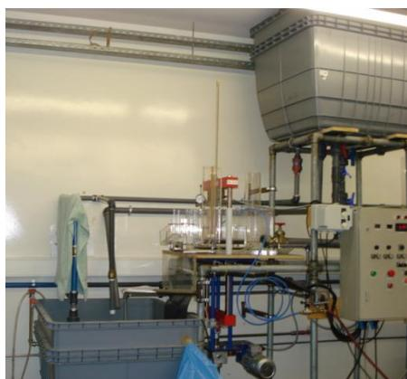
Figura 5. 5: Equipamento utilizado para o ensaio de determinação da capacidade de escoamento no plano de um geossintético
