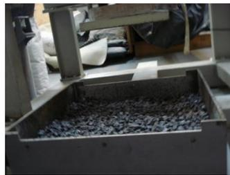
Figura 5. 17: Ensaio de dano mecânico – Parte inferior da caixa de danificação preenchida com as duas camadas de óxido de alumínio normalizado
