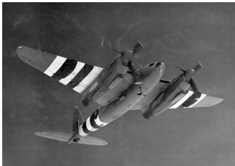
Figura 1.8: Avião Haviland Mosquito, esta aeronave foi pioneira no uso de materiais sanduíche (Contraplacado com núcleo de balsa) [6]
