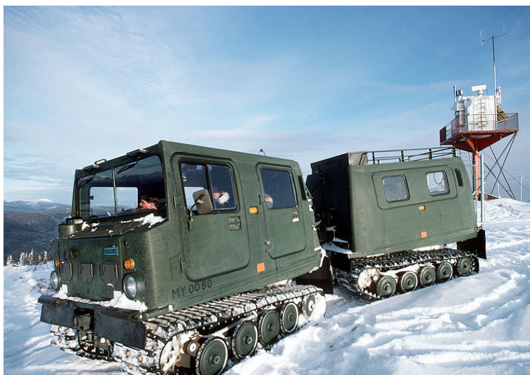
Figura 1.9: Veículo Bv 206, este veículo é construído com recurso a estruturas sanduíche utilizando o método RTM, assim se obtêm um baixo peso que é uma vantagem nas deslocações fora de estrada [7]
