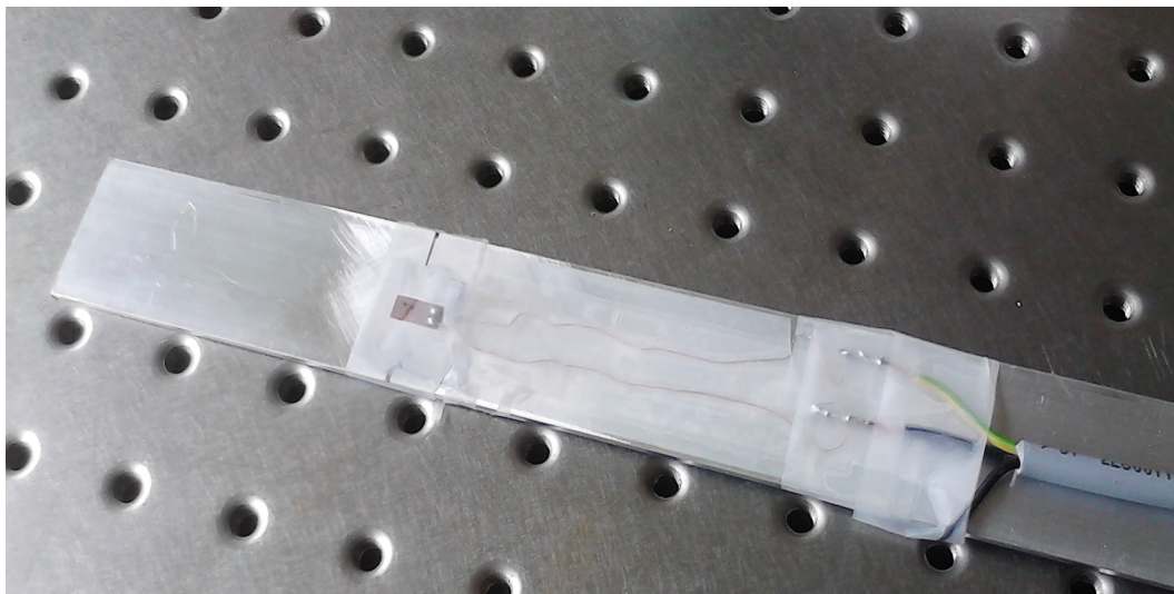
Figura 4.1: Ilustração da fase final da colocação do extensómetro
