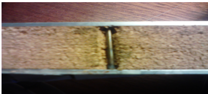
Figura 4.3: Ilustração dos reforços para impedir a compressão da cortiça
