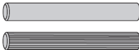
Figura 52 – Configuração típica de cavilha [Silva, 2009]
