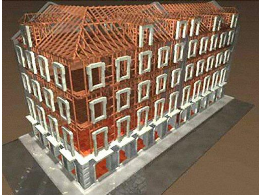
Figura 13 – Construção do tipo Gaioleiro [ http://blog.uncovering.org/archive/2005/11/engenharia_pomb.html ]
