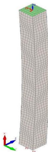
Figura 61: Modelo da viga-coluna com as imperfeições globais e locais aplicadas
