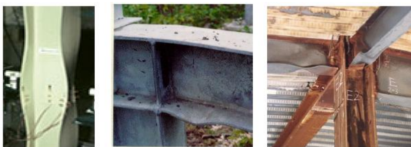
Figura 12: Fenómeno de Encurvadura Local para barras de aço em forma de I [7]
