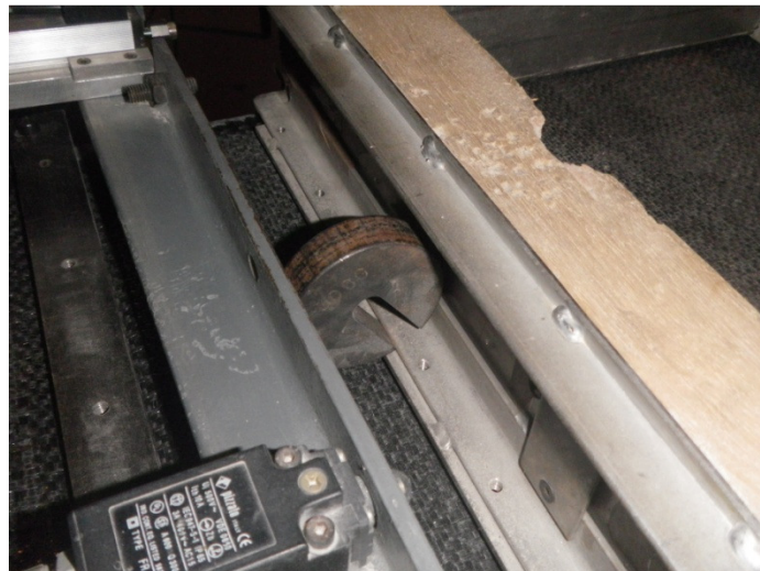
Figura 47. Travamento do movimento da caixa superior durante enchimento e compactação do solo.
