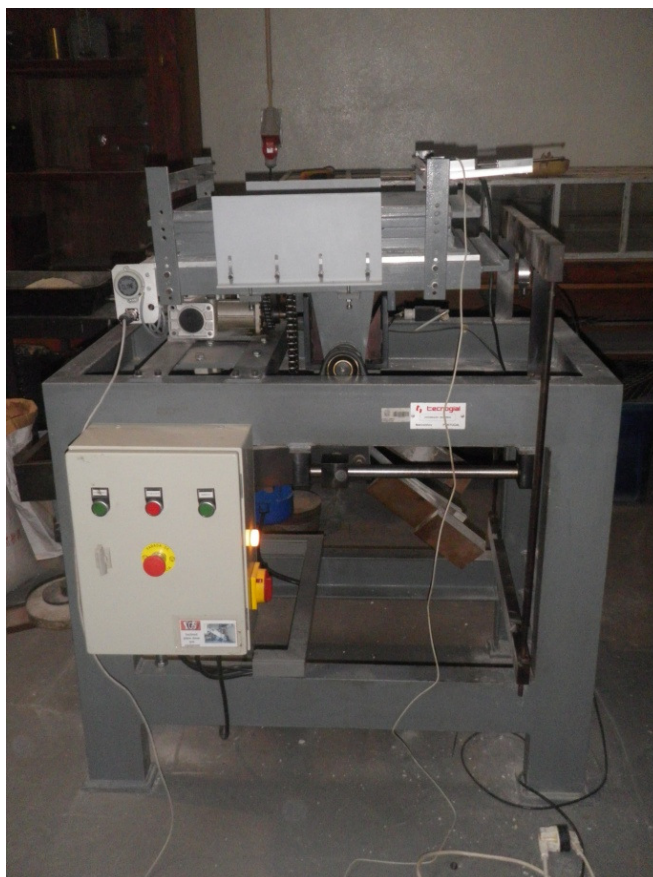
Figura 24. Máquina de Ensaio de Corte em Plano Inclinado da FEUP.
