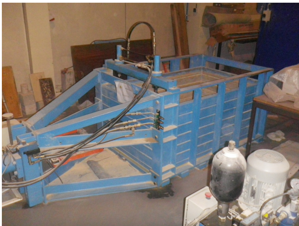
Figura 12. Equipamento Exclusivo de Ensaio de Arranque da FEUP.
