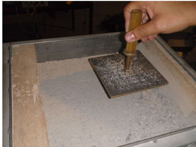
Figura 46. Compactação do solo na caixa superior durante a montagem do ensaio de corte em plano inclinado
