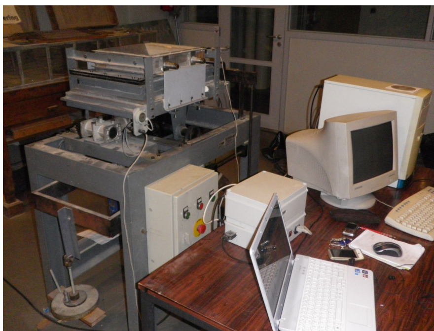
Figura 48. Vista geral do conjunto de equipamentos utilizado na realização dos ensaios de corte em plano inclinado: máquina de ensaio de CPI, sistema de aquisição de dados e computadores para processamento e armazenamento de dados.
