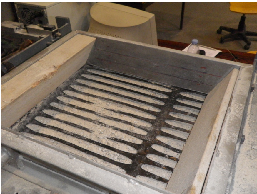
Figura 37. Caixa superior do aparelho de ensaio - cunhas laterais para garantir passagem da linha de ação da força normal pelo centro de gravidade da caixa.
