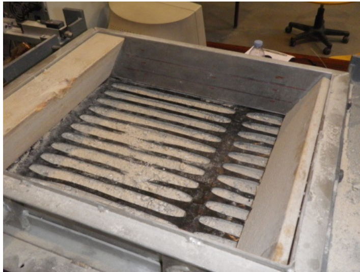
Figura 45. Aparelho de corte em plano inclinado- colocação da caixa superior.
