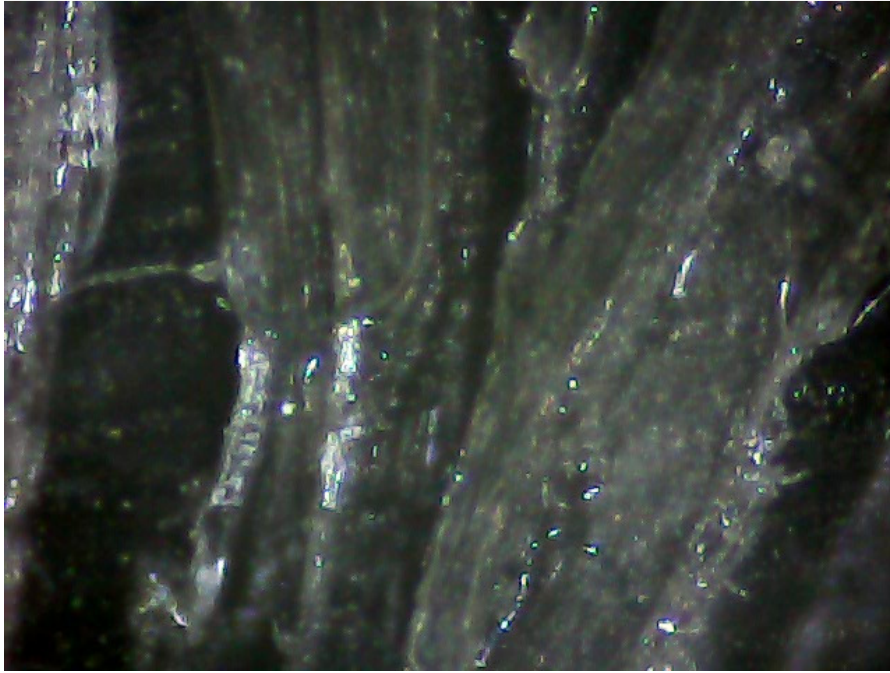
Imagem 12: Superfície do filamento de GTX , DDI EC2, ampliação 80X
