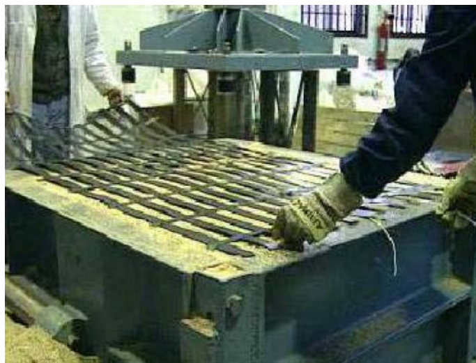
Figura 16. Preparação de ensaio de corte direto para interface solo-geogrelha-solo (Sieira, 2003).
