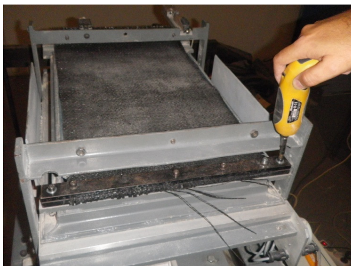
Figura 27. Fixação do geossintético na caixa inferior.
