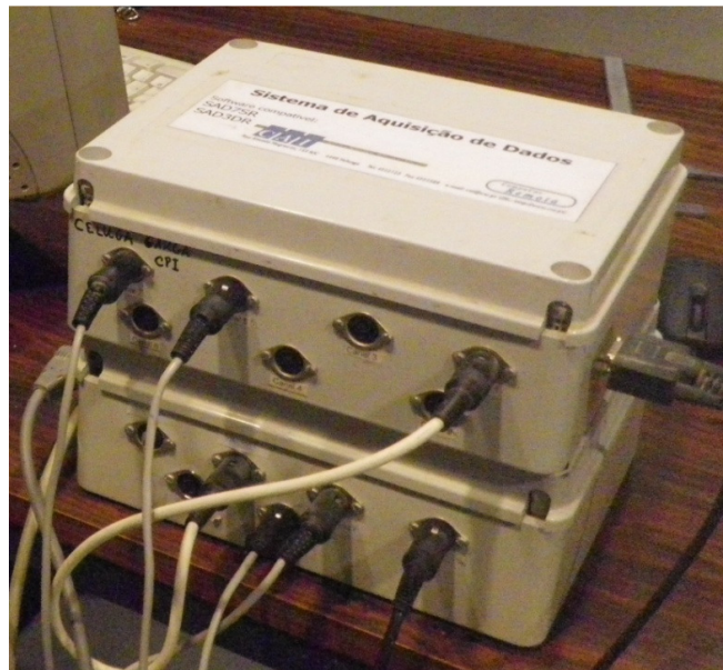
Figura 42. Sistema de aquisição de dados do equipamento de ensaio de CPI da FEUP.
