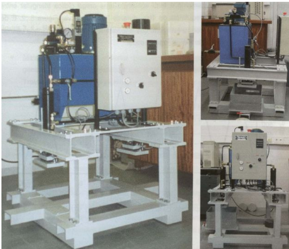
Figura 2. Equipamento de Danificação de Geossintético da FEUP. Adaptado de (Paula, 2003)
