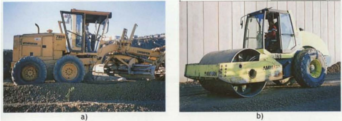
Figura 57. Equipamentos utilizados para; a) espalhamento e nivelamento; b) compactação (adaptado de (Lopes et al., 2001)).
