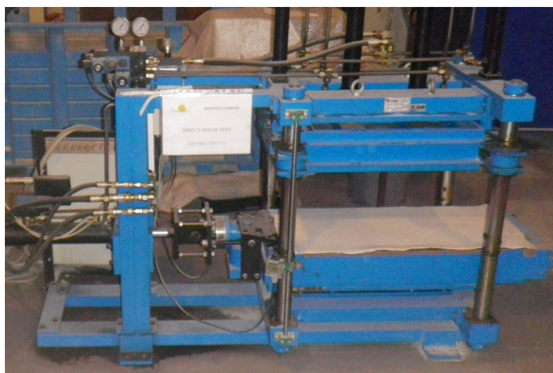
Figura 14. Equipamento de ensaio de corte direto da FEUP.
