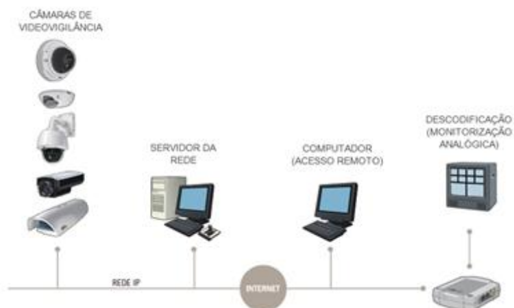
Figura 4.9 Exemplo de uma possível arquitetura de uma implementação de um CCTV numa casa digital [68]
