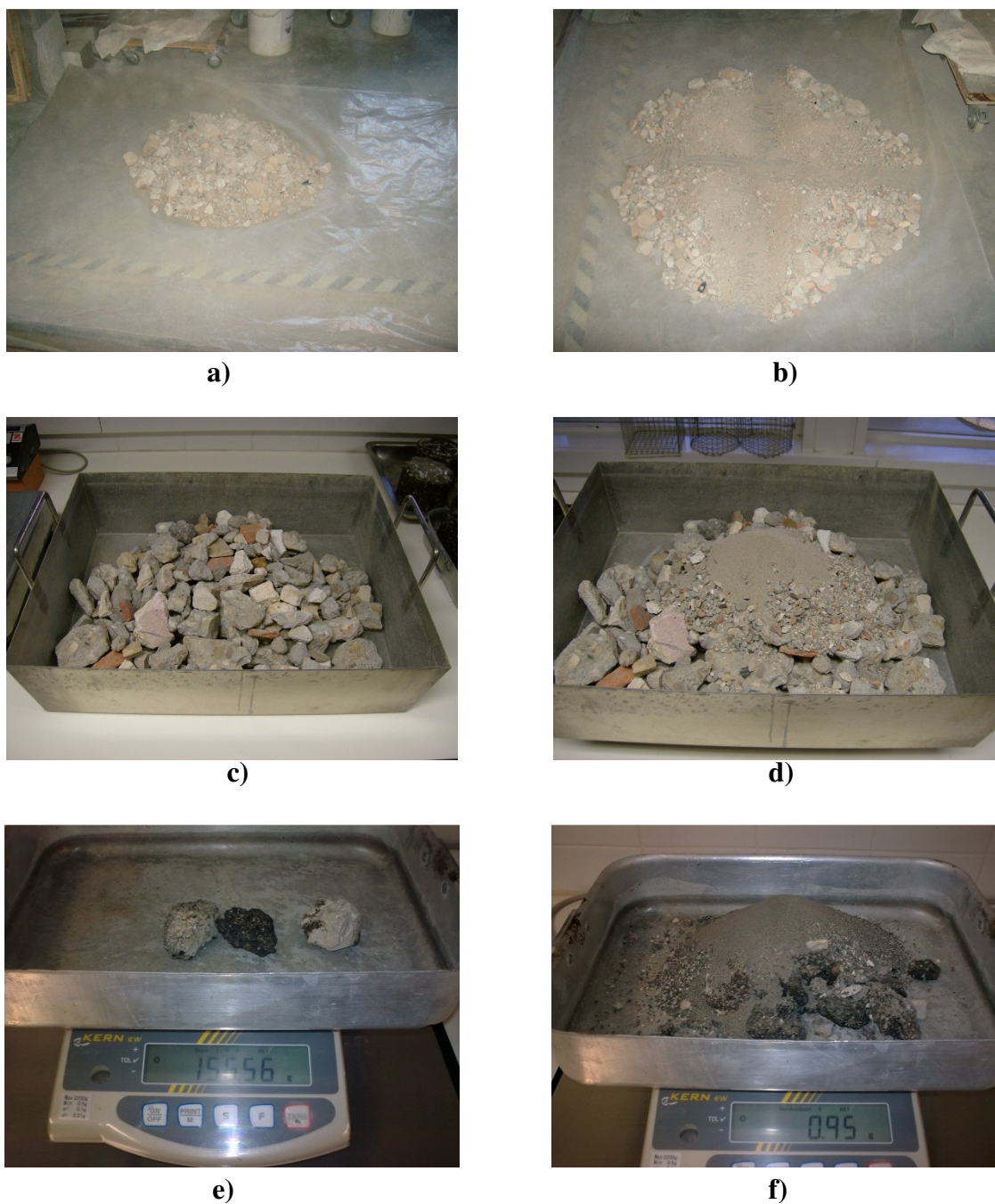
Figura 13. Ensaio de granulometria. a) e b) Esquartelamento da amostra (processo efetuado apenas para as amostras 3 e 4); c) Pesagem do material mais grosseiro de uma amostra de RCD; d) Pesagem do material mais fino de uma amostra de RCD; e) Pesagem do material mais grosseiro de uma amostra de RCD betuminoso; f) Pesagem do material mais fino de uma amostra de RCD betuminoso
