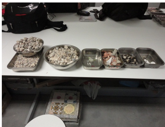
Figura 12. Foto do ensaio de classificação dos agregados reciclados grossos
