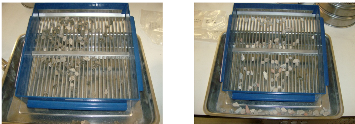
Figura 19. a) Ensaio índice de achatamento. a) RCD betuminoso; b) RCD.
