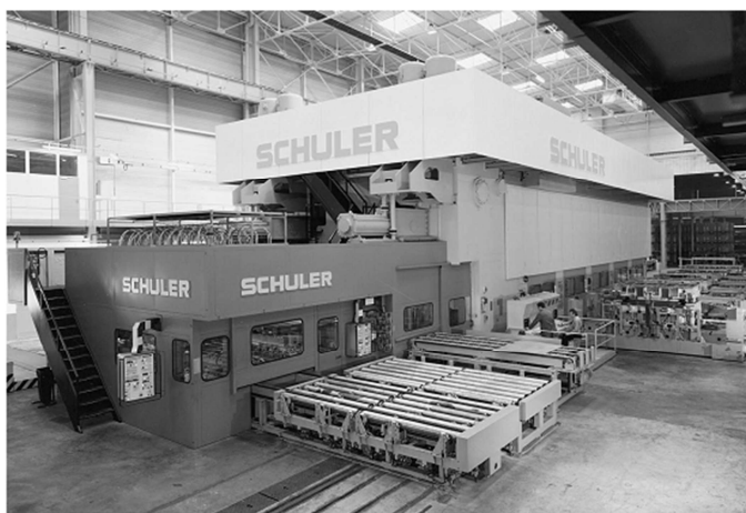
Figura 3 – Sistema de desempilhamento e transporte por correias magnéticas [3]
