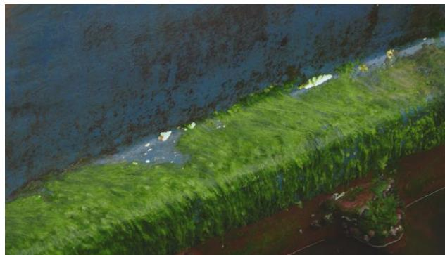
Figura 1.1. Fotografia exemplificativa do fenómeno de bioincrustação no casco do navio “Snabmar” após uma viagem de 6 meses em alto mar. Porto de Pesca Longínqua, Aveiro, Portugal.
