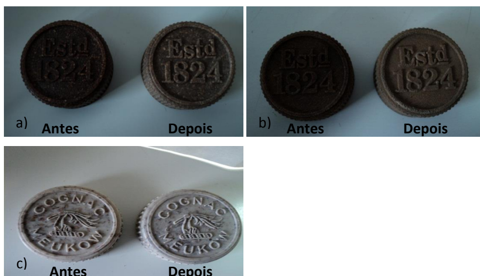
Figura 4.11: Cápsulas de compósito a)P1, b)P2 e c)E1 antes e depois do teste de resistência ao álcool.
