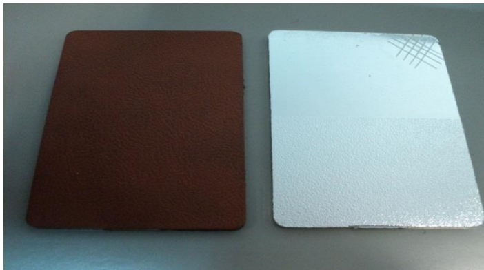
Figura E.2.1: Compósito Poliamida antes e depois da metalização.
