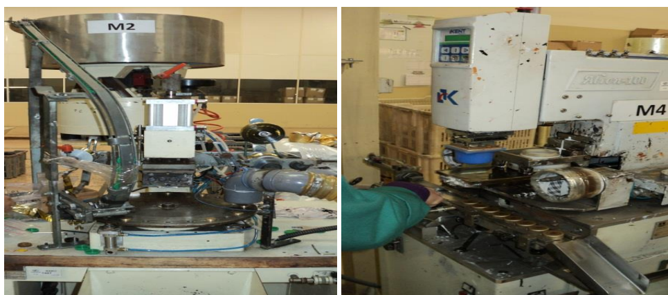
Figura 3.8: Máquinas utilizadas para personalização das cápsulas: HotStamping e Tampografia, respectivamente.
