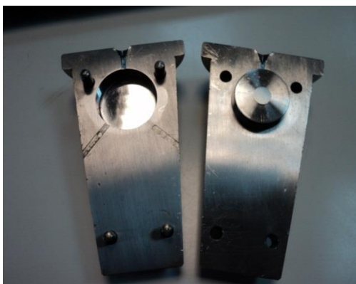
Figura 3.2: Molde projetado para injeção dos materiais selecionados.
