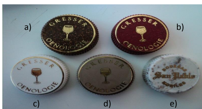
Figura 4.12: Cápsulas estampadas por Hotstamping : a) compósito P1; b) compósito P1 com pigmento; c) PLA/PBAT; d) PLA/PBAT com pigmento; e) compósito E1.
