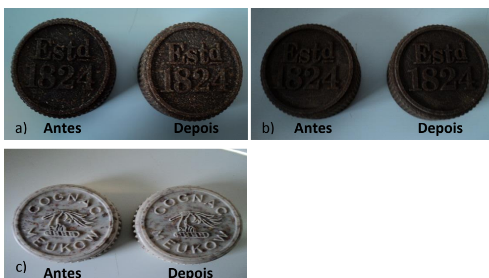
Figura 4.10: Cápsulas de compósito a) P1, b) P2 e c) E1 antes e depois do teste de resistência térmica.
