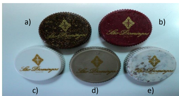
Figura 4.13: Cápsulas estampadas por Tampografia: a) compósito P1; b) compósito P1 com pigmento; c) PLA/PBAT; d) PLA/PBAT com pigmento; e) compósito E1.
