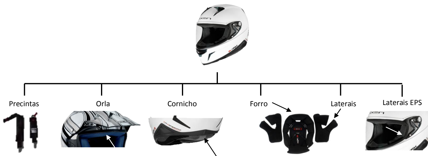
Figura 21: Partes constituintes de um capacete
