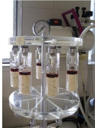
**Figura 14** - Aparelho utilizado para testar a vedação em tubo das rolhas.
