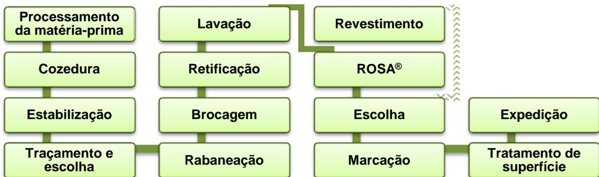
Figura 11 - Fluxograma simplificado do processo de fabrico de rolhas de cortiça natural.
