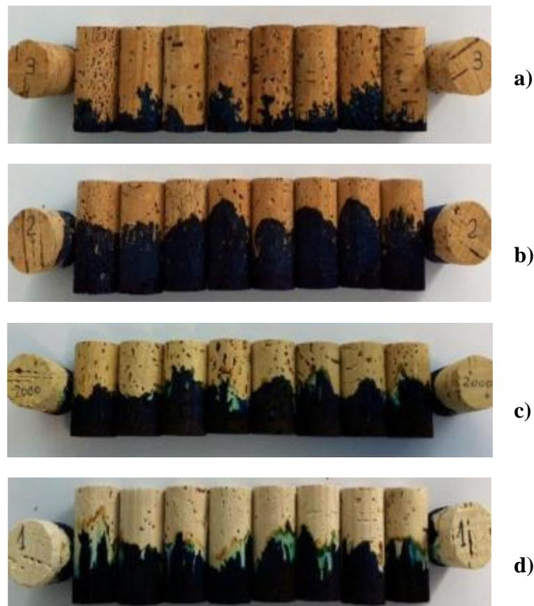
**Figura 19** – Efeito de capilaridade em rolhas acabadas de brocar a) e rolhas provenientes de diferentes lavagens existentes na A&I (b, c) e d)).
