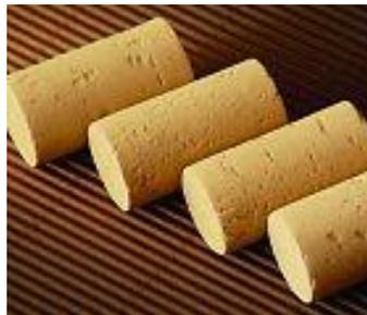
**Figura 8** - Exemplo de rolhas de cortiça natural colmatadas.(1)
