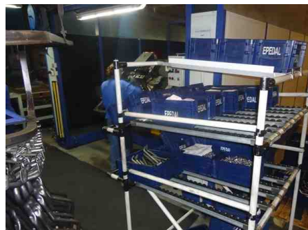
Figura 22 - Rack de abastecimento
