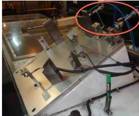
Figura 27 - Poka-yoke de Embalamento com Sistema Pneumático de Verificação de Furação
