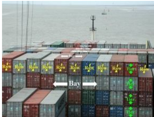
Figura 5 Tipologias de posição no cais Bay - Row – Tier ( http://www.containerhandbuch.de , 2012)
