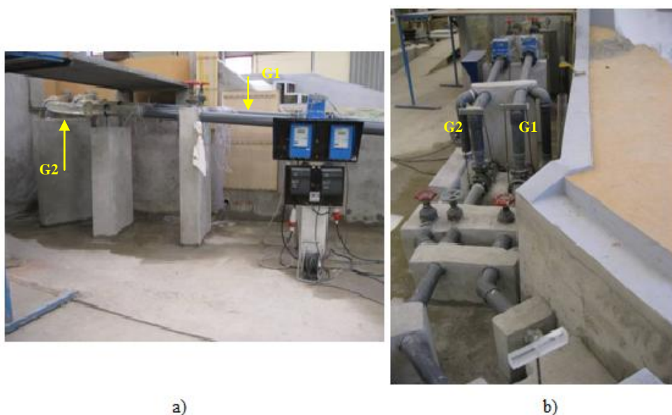
Figura 15. Modelo físico da barragem de Foz Tua. Galerias dos circuitos de produção de energia
