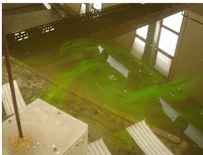
Figura 25. Formação de dois pequenos vórtices junto da tomada de água para Q=2 \times 4,42 l/s e NmE
