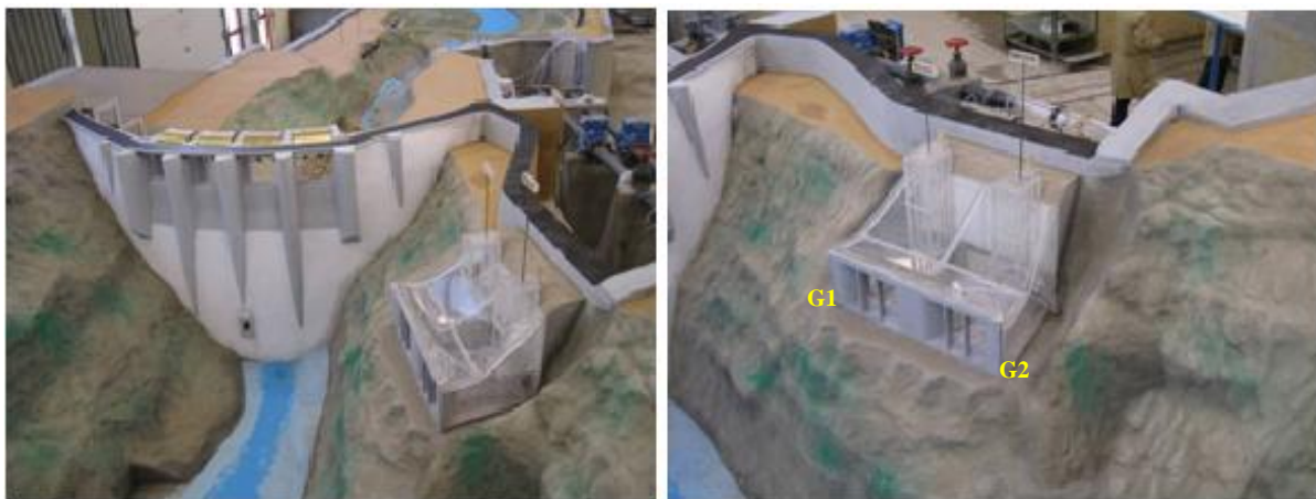
Figura 13. Modelo físico da barragem de Foz Tua. Vista da tomada de água na albufeira
