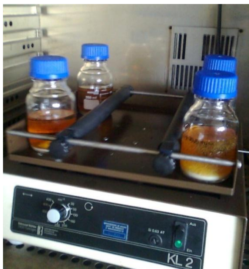
Figura 9 Esquema experimental usado na reação de transesterificação e esterificação do OAU.
